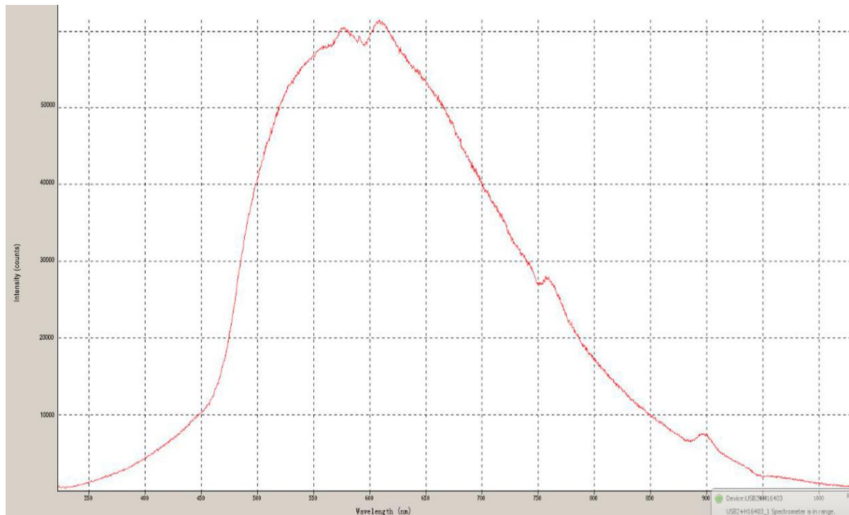
Figura 14 - Espectro da lâmpada halógena obtido com o espectrômetro
