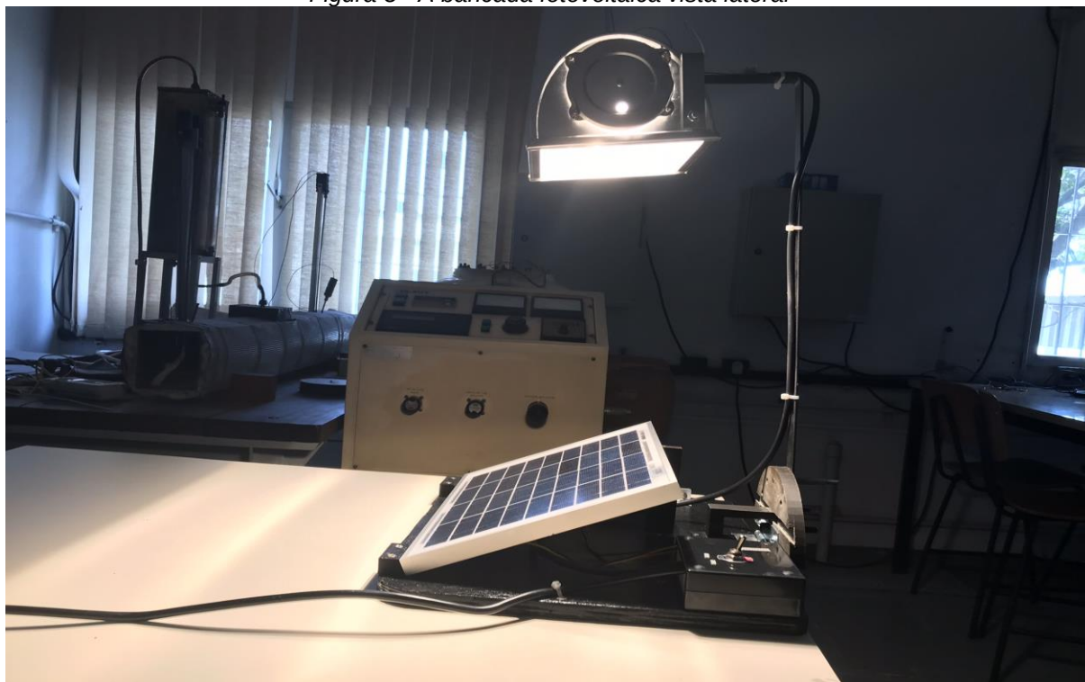
Figura 5 - A bancada fotovoltaica vista lateral
